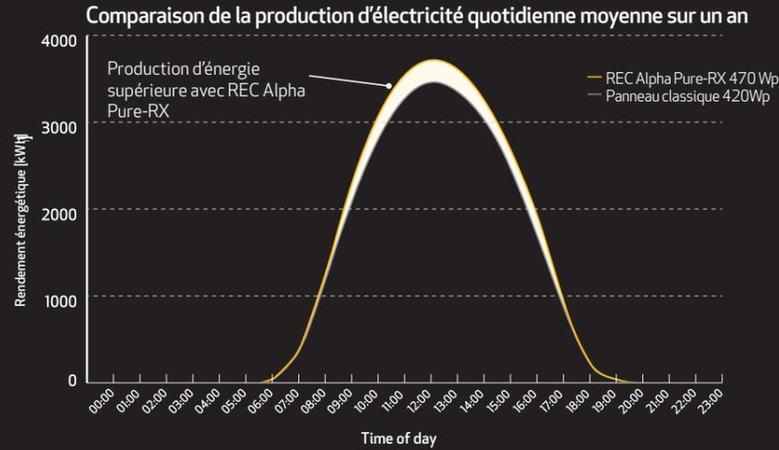
Calculs basés sur des résultats de simulation pour une année complète et un système de 1,2 kWp à Palm Springs, Californie, États-Unis. Différence de rendement max. de REC Alpha Pure-RX à midi : +6%, avec un rendement annuel généralement supérieur de 5,7%. Performances variables selon le lieu.
